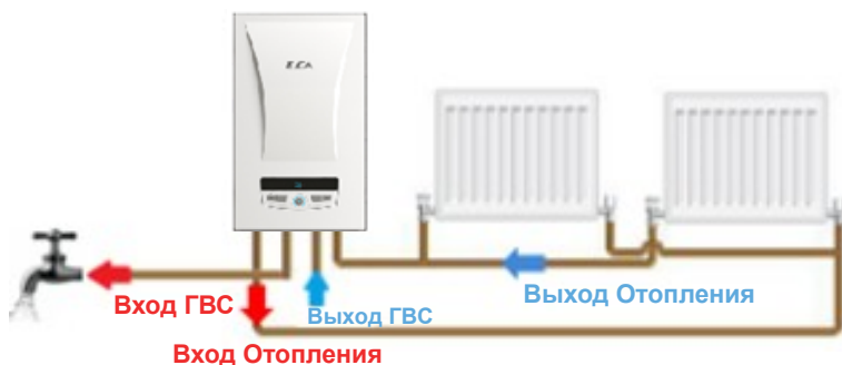
Рисунок 7. Схема Подключения Установки Монотермического Устройства.
