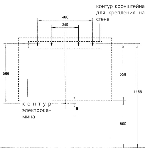
Иллюстрация 2: Рекомендуемые крепежные размеры
