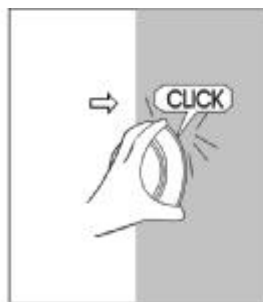
Поворачивайте диффузор до тех пор, пока он не защелкнется в нужном положении.
