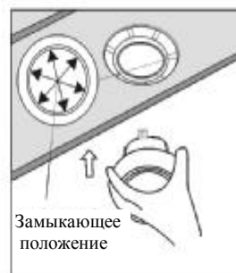
Установка диффузора в корпусе. Одна насечка должна быть направлена в середину места фиксации.
