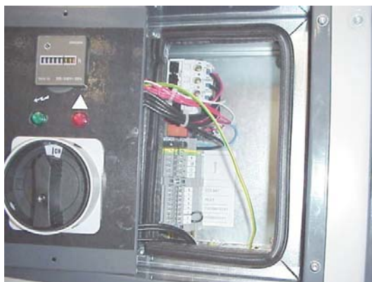
Рис. 4.1 Контактная колодка расположена за правой панелью управления.
