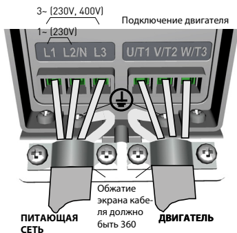
Рис. 10: Подключение силовых кабелей преобразователя Vacon 20, MI1
