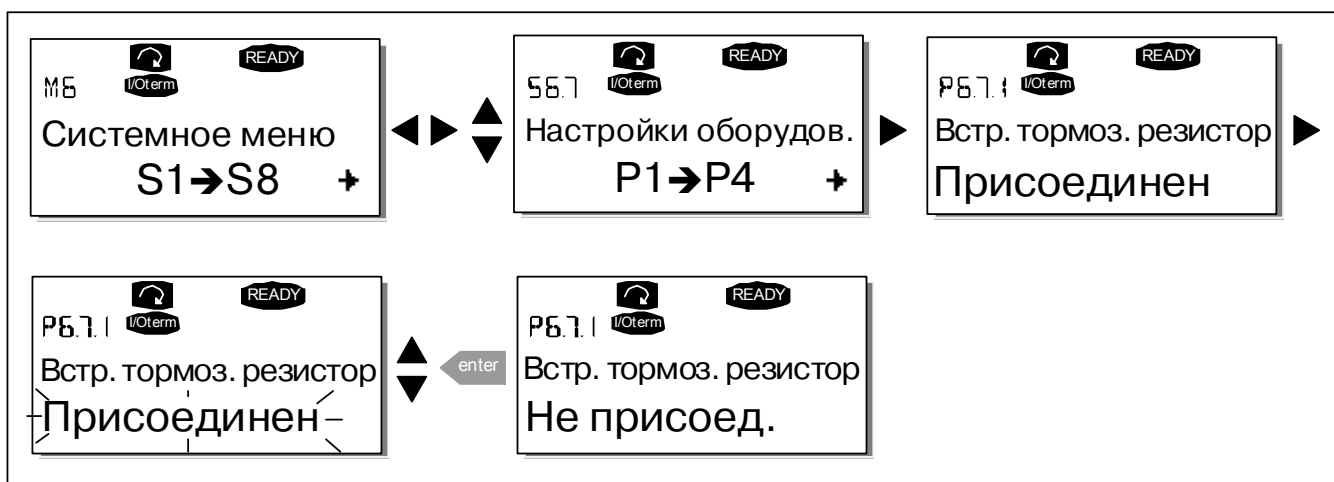
Рисунок 7-21. Подключение встроенного тормозного резистора
