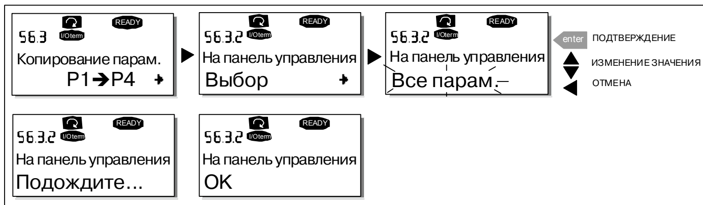
Рисунок 7-12. Копирование параметров в панель управления
