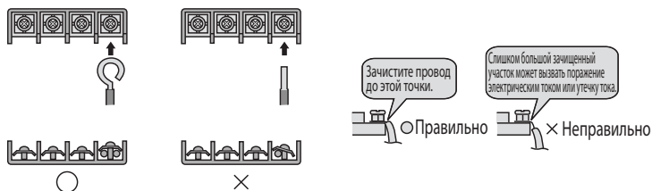
Зачистка провода на клеммной колодке
