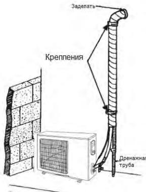
(2). Если наружный блок находится над внутренним блоком, расположите трубопровод в соответствии со следующей схемой.
