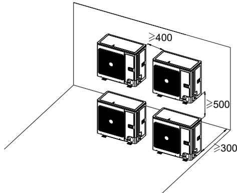
(2) Схема места установки и пространства для внутреннего блока (Примечание: для обеспечения максимальной производительности внутреннего блока убедитесь, что его место для установки соответствует следующим установочным размерам).
