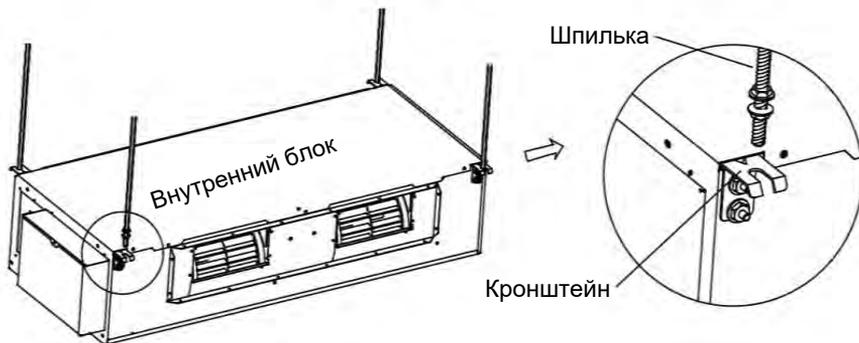
(4) Проденьте кронштейны устройства в болты, установленные на потолке, и установите блок с помощью специальной гайки. См. Следующий рисунок.
