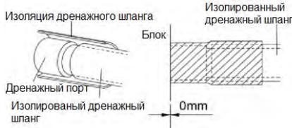
(10) Неиспользуемый сливной порт также должен быть правильно изолирован. См. Следующий рисунок.
