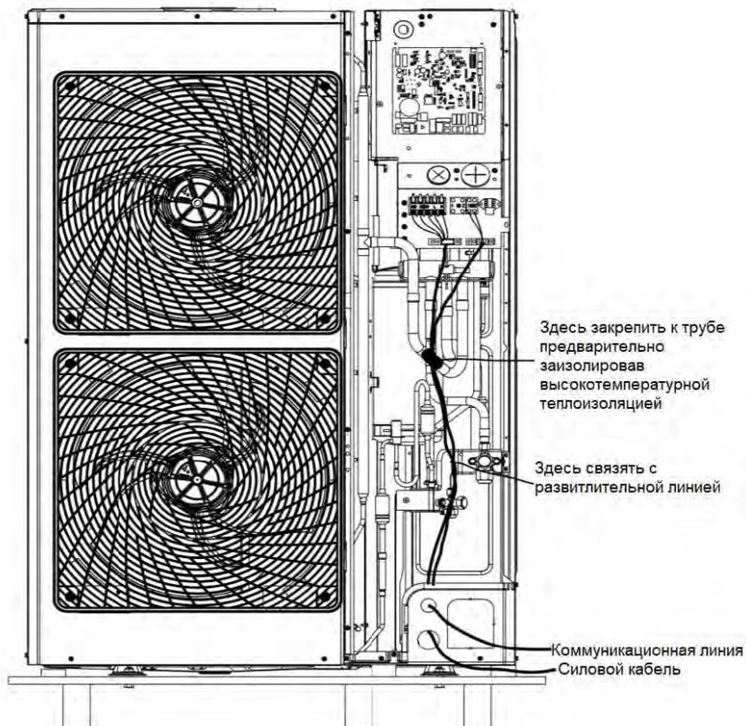
б) Проводка унифицированного источника питания для трехфазного источника питания.
