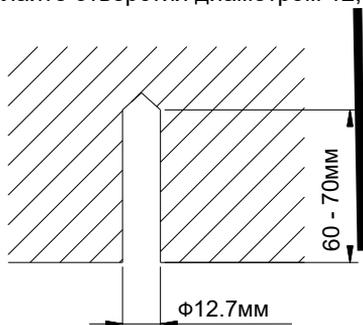
(2) Вставьте анкерные болты в просверленные отверстия и полностью забейте штыри в анкерные болты с помощью молотка. См. Следующий рисунок.
