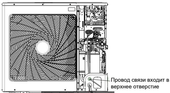
Силовые кабели наружного и внутреннего блоков входят в нижнее отверстие.
