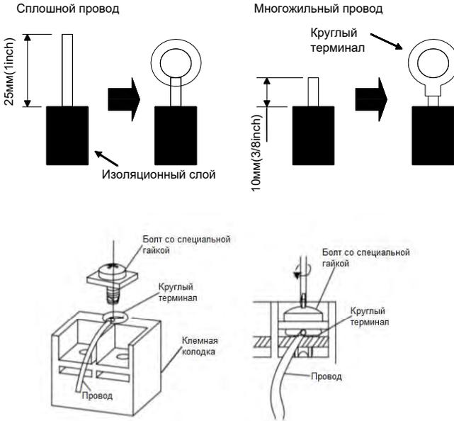
(3) Как подключить соединительный провод и шнур питания.
