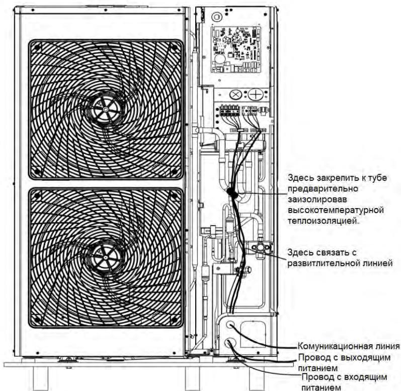
Шнур питания должен быть закреплен вместе с правой боковой пластиной и закреплен на крюке с помощью проволочного зажима, чтобы избежать контакта с трубопроводом. Линия связи между внутренним и наружным блоками также должна быть уложена вместе с правой боковой пластиной, но подальше от шнура питания.
