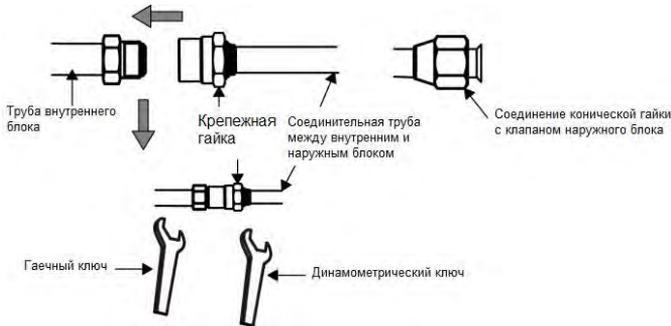
Способ установки: сначала подключите соединительные трубки к внутреннему блоку, а затем к наружному блоку. При изгибе соединительной трубы будьте осторожны, чтобы не повредить трубу. Не затягивайте гайку слишком сильно, иначе произойдет утечка. Кроме того, снаружи соединительной трубы следует добавить слой изоляционного хлопка, чтобы защитить его от механических повреждений во время установки, обслуживания и транспортировки.
