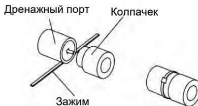
(9) Заизолируйте, место подключения дренажного порта и сливной шланг. См. Следующий рисунок.
