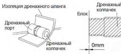
(11) На одной стороне изоляции есть клей, так что после снятия защитной бумаги изоляция может быть непосредственно прикреплена к дренажному шлангу.
