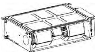
(2) Если используется метод обратного потока снизу, установите крышку обратного воздуха на задней панели устройства.
