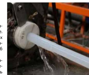
Трубы из сшитого полиэтилена изготавливаются на заводе в г. Невер.
