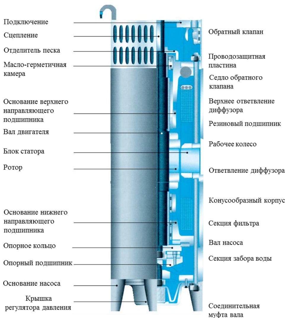
Рисунок 12. Структура двигателя погружного агрегата насосного SM
