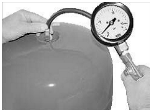
Рис. 9 Контроль давления в мембранном баке
