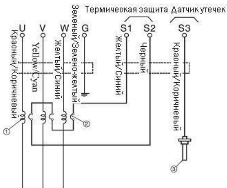
Рис. 12 Электрическая монтажная схема прямого включения (2)
