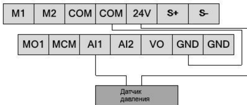
Схема подключения двухпроводного датчика давления
