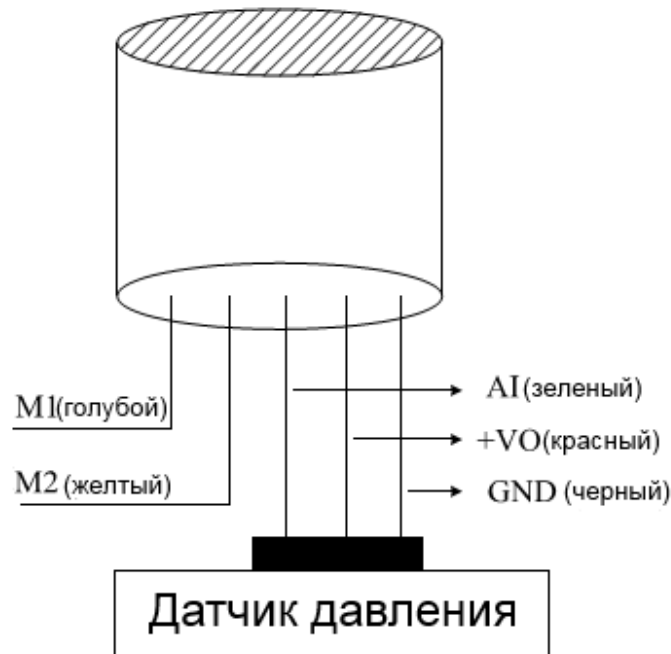
Схема подключения трехпроводного датчика давления
