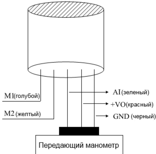
Схема подключения передающего манометра
