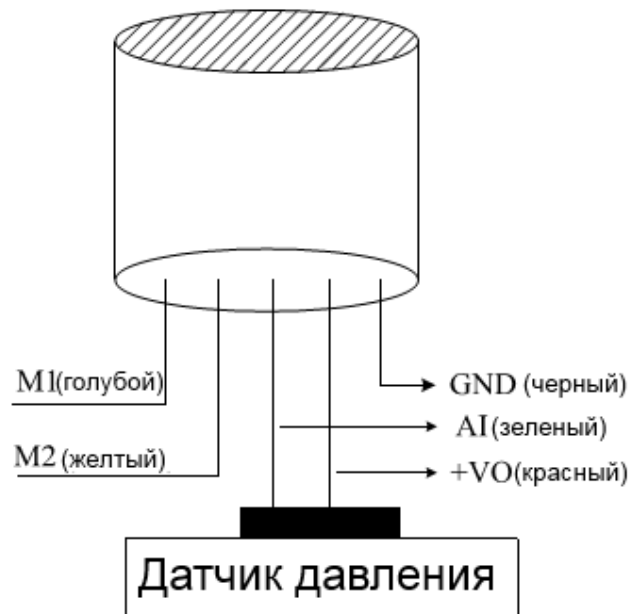
Схема подключения двухпроводного датчика давления
