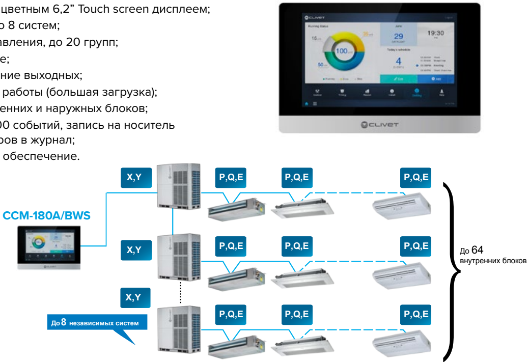
Образец схемы подключения центрального пульта CCM-180A/BWS
