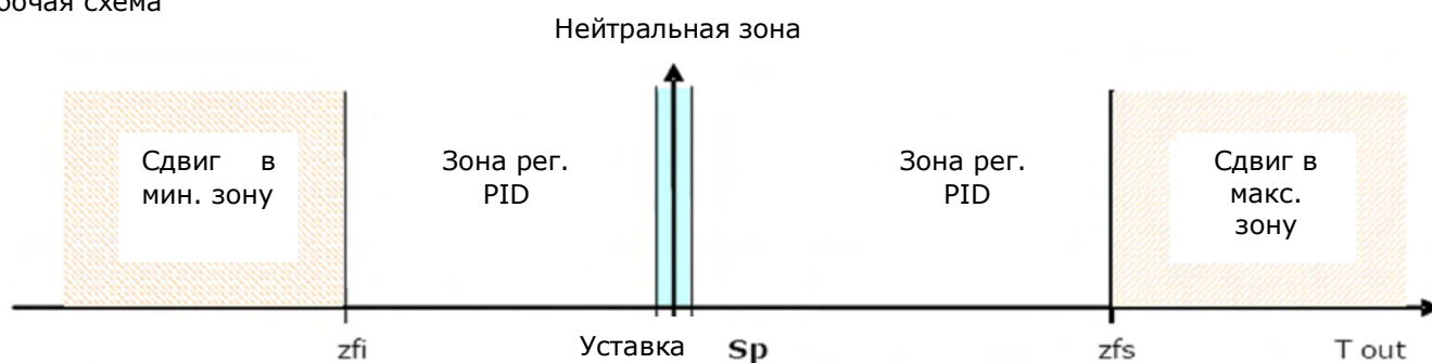
Рис 1.12. рабочая схема регулирования DIP по выходу
