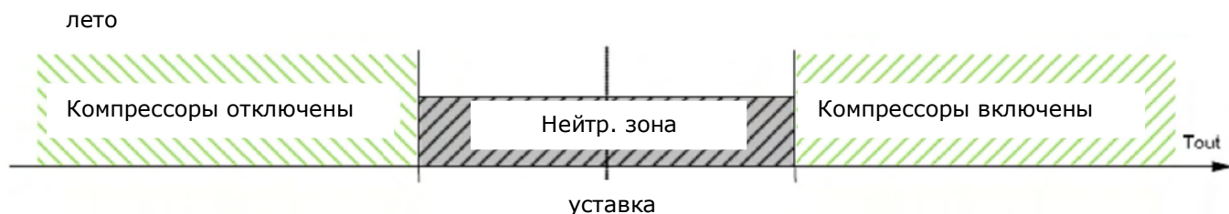
Рисунок 1.13: регулирование нейтральной зоны по температуре на выходе
