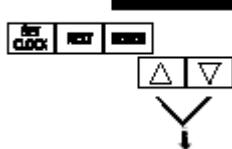
Нажмите одновременно на 3 секунды кнопки «▲» и «▼». Если в течении 5-ти секунд не произойдет перехода к шагу №2 – управляющий клапан будет заблокирован. Чтобы снять блокировку следует нажать кнопки: ▼, NEXT, ▲, SET CLOCK в указанной последовательности. Затем нажмите одновременно в течении 3-х секунд кнопки «NEXT» и «▼» и отпустите их.
