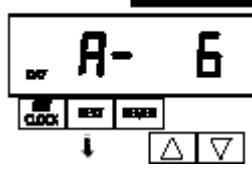
Объем, резервная емкость, использованная за последние 7 дней. В этом режиме отображается оставшаяся обменная емкость. С помощью кнопки «▲» можно посмотреть данные по оставшейся обменной емкости за прошедшие дни (максимум за неделю). С помощью кнопки «▼» можно «пролистать» данные в обратную сторону.
