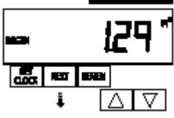
На этом этапе отображается объем очищенной воды с момента последней регенерации. Если управляющий клапан не оснащен водосчетчиком, то на дисплее будет отображаться ноль. Нажмите кнопку «NEXT» для перехода к следующему шагу, либо нажмите кнопку «REGEN» для возврата к предыдущему шагу.
