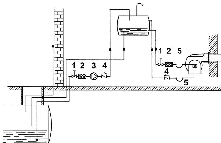
Рис. 4 - Кольцевой контур подачи топлива
