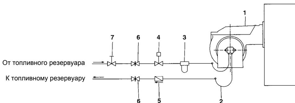
Рис. 6 - Двухтрубная система
