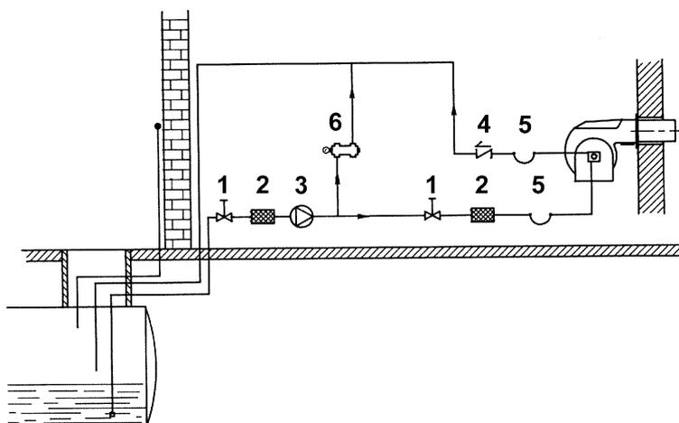
Рис. 5- - Контур подачи топлива всасыванием
