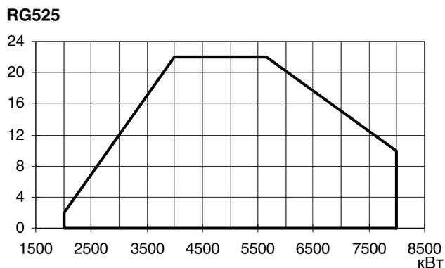
Чтобы получить мощность в ккал/ч, умножьте значение в кВт на 860. Эти данные относятся к стандартным условиям: при атмосферном давлении в 1013 мбар и температуре окружающей среды в 15°C.
