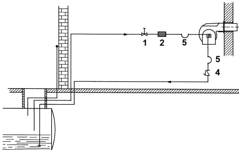
ПРИМЕЧАНИЕ: в системах с гравитационной подачей или с кольцевым контуром, установить автоматическое отсечное устройство (см. № 4-Рис. 6).
