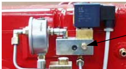
Рис. 15 - Распределительный блок дизтоплива (PG60)
