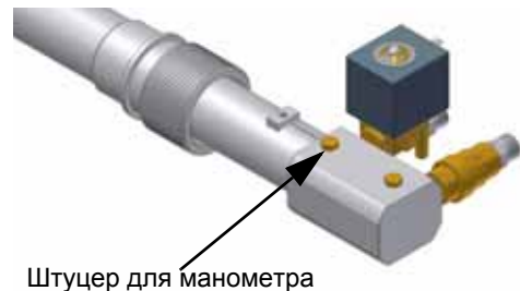
Рис. 16 - Голова сгорания с фурмой дизтоплива (PG70 - PG81)
