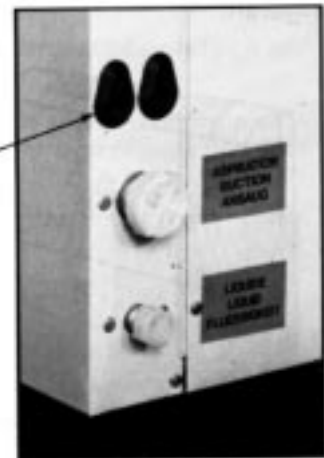
Sorties pour les câbles électriques Exit for electrical cables
