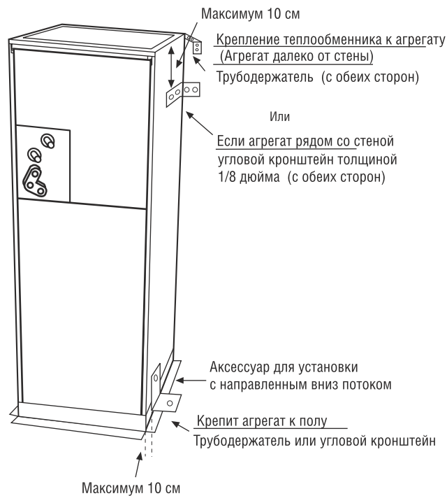
Рис. 7— Крепление блока
