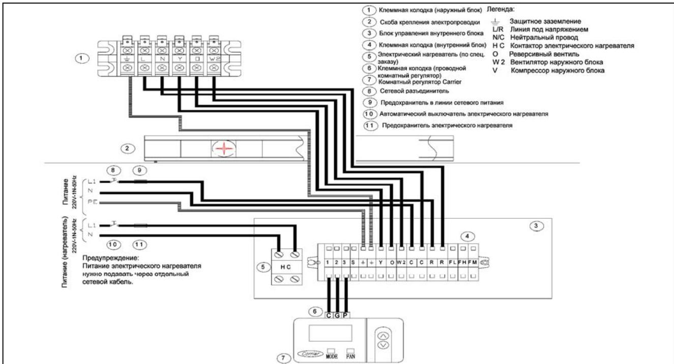
Тепловой насос (питание однофазным напряжением от внутреннего блока)
