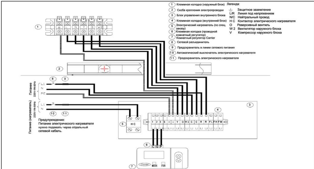
Тепловой насос (питание однофазным напряжением от наружного блока)
