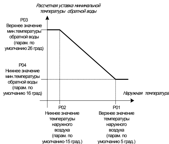
Зависимость расчетной минимальной температуры обратной воды от наружной температуры
