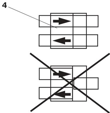
Переключающий клапан (4) установить так, чтобы циркуляция шла через входное отверстие в направлении стрелки (см. рисунок). Включить сетевой выключатель (2).
