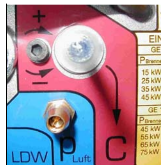
Рис. 19: Настроечный болт Logatop GE1H с мерной В- шкалой
