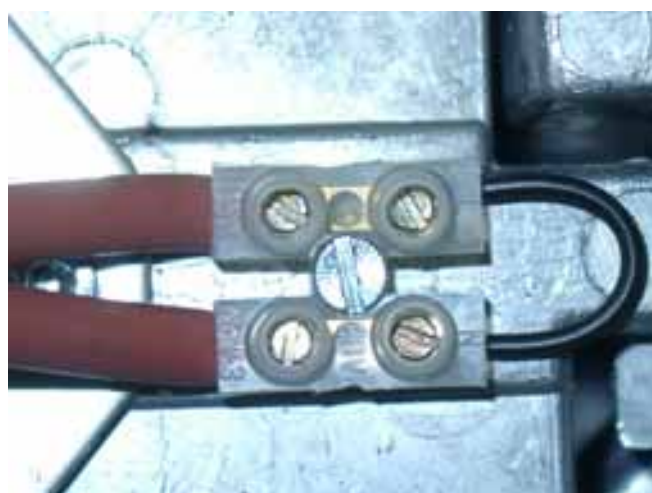
Рис. 26: Перемычка для измерения ионизационного тока
