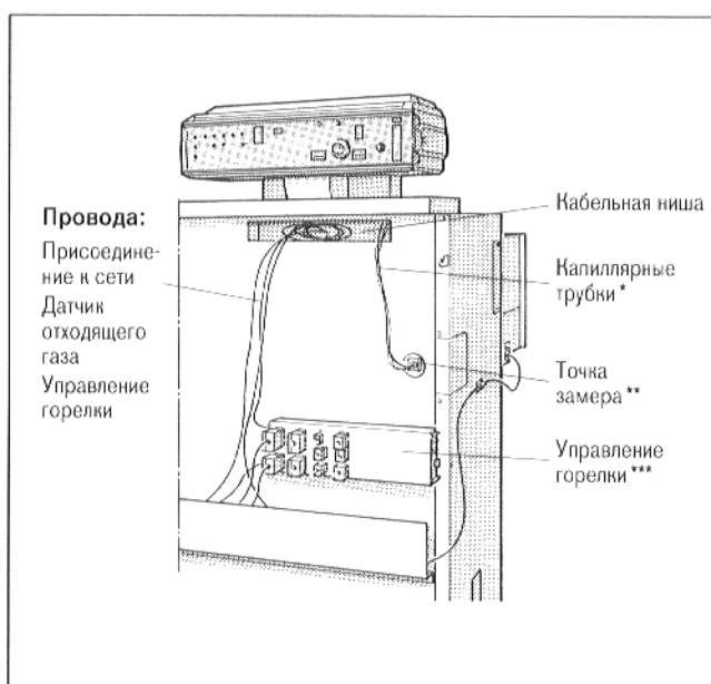
Рис. 38 – передняя сторона котла со снятой передней стенкой
