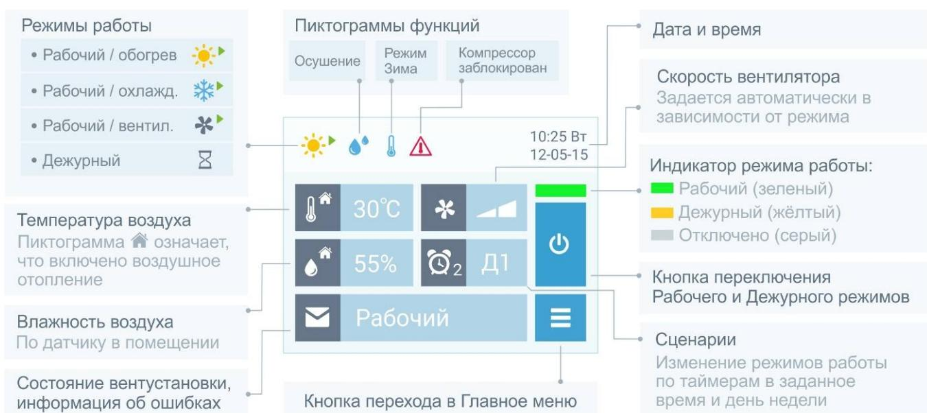
В верхней строке экрана расположены пиктограммы, показывающие режим работы и состояние вентустановки. Иконка «Компрессор заблокирован» появляется в режиме охлаждения при слишком высокой температуре воздуха внутри или снаружи помещения.
