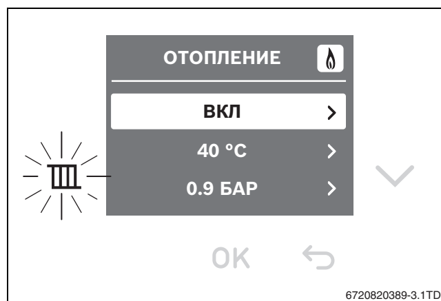
Рис. 10 Меню температуры котла
