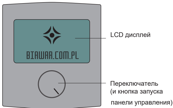
Рис. 8 Панель управления (домашняя заставка)
