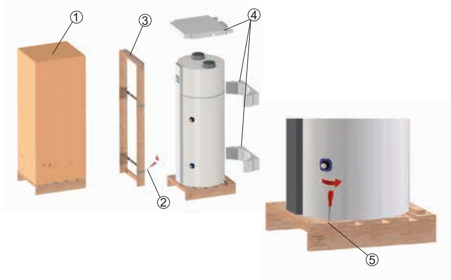
Rys. 10 – Kolejność demontażu stelażu transportowego
