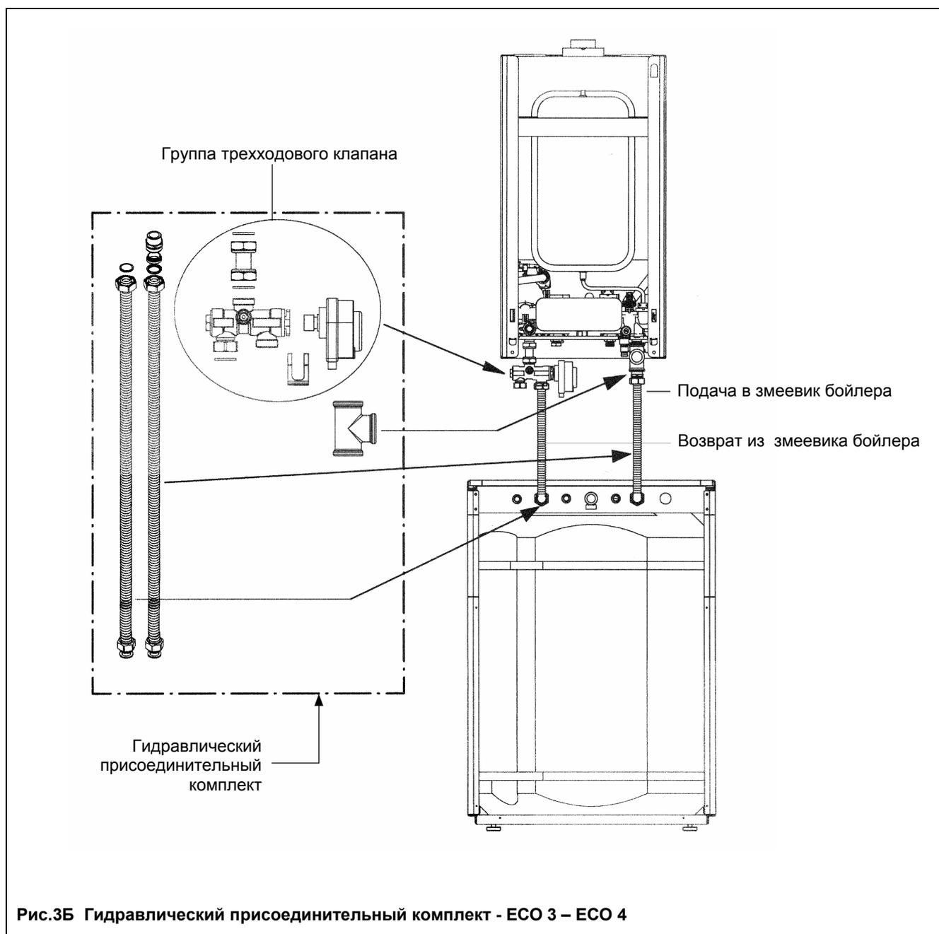
Рис.3Б Гидравлический присоединительный комплект - ECO 3 – ECO 4
