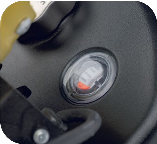
Встроенный датчик уровня топлива
