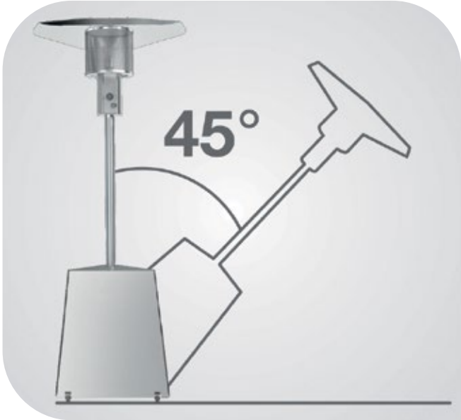
Автоматическое отключение при падении
