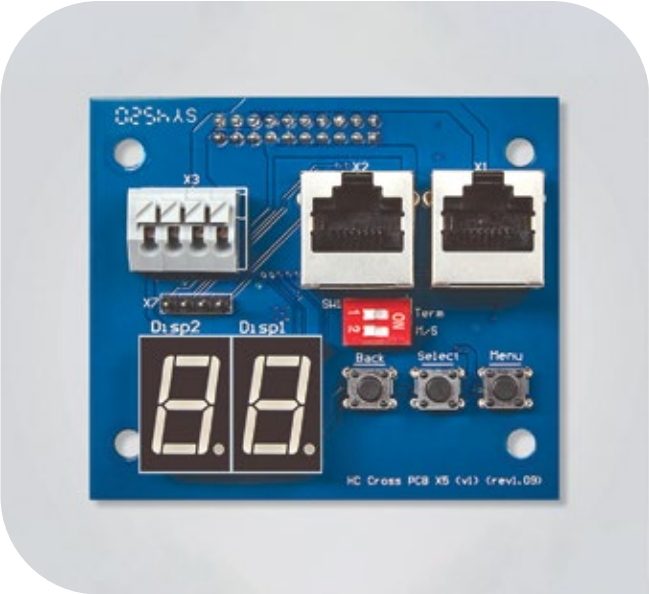
Низковольтное управление, подключение кабелем RJ-45
