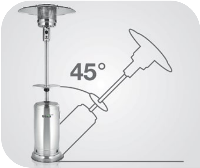
Автоматическое отключение при падении
