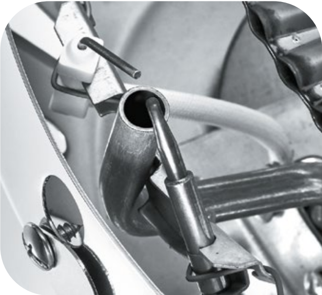
Контроль пламени и защита от утечки газа
