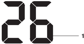
1 – Индикатор текущей температуры
