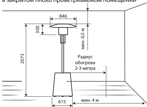
Рис. 1в – Размеры прибора и допуски (0,5 min)
