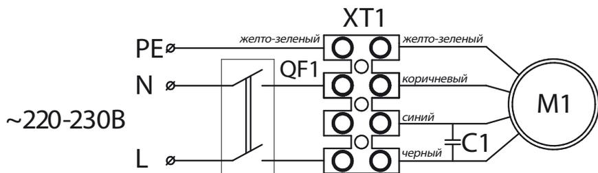
XT1 - клеммная колодка; C1 - конденсатор;
