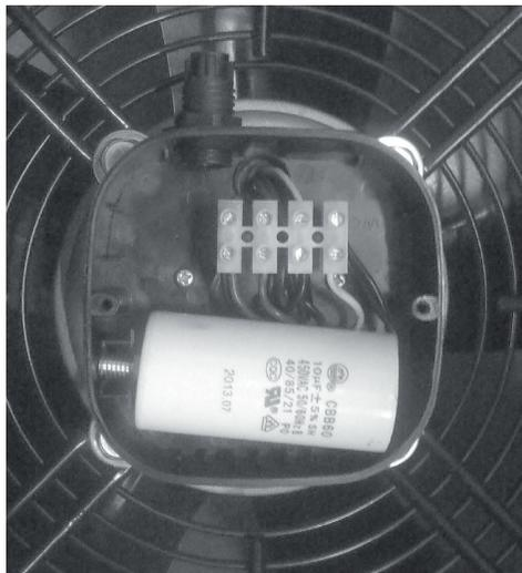
Минимальное сечение электрических проводов – 1 мм<sup>2</sup>
