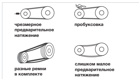
Рис. 7. Натяжение ремней
