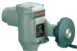
Неполнооборотный привод AS 6 – AS 50 крутящий момент от 25 до 500 Нм время позиционирования дл 90° от 4 до 90 сек.
