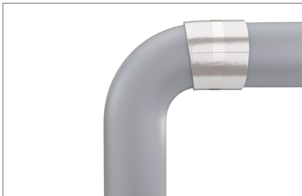
Рисунок 17: Монтаж первого сегмента
