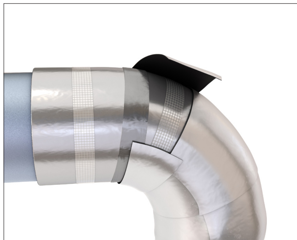
Рисунок 67: Установка сегментов первичного паробарьера
