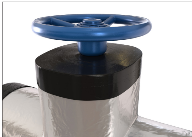
Рисунок 55: Нанесение пароизоляции на шпindelь арматуры
