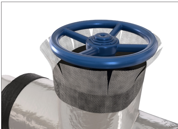
Рисунок 56: Установка гибкой усиливающей мембраны на оконечность изоляции шпинделя
