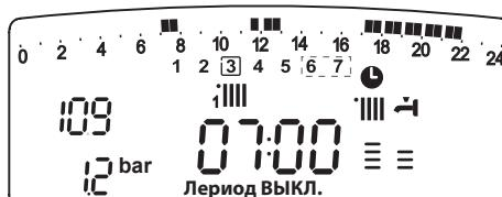
Наряду с изменением интервала времени, дисплей с помощью индикатора часов указывает выбранное время с шагом 15 мин. По завершении изменения интервала предварительно заданной программы, нажимая кнопку "Таймер-программатор", выберите другой интервал, в нашем примере это период с 07:00 по 22:00.
