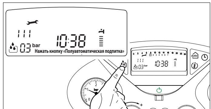
Котел следует перезапустить, а контур отопления подпитать, нажав кнопку "Полувавтоматическая подпитка".
