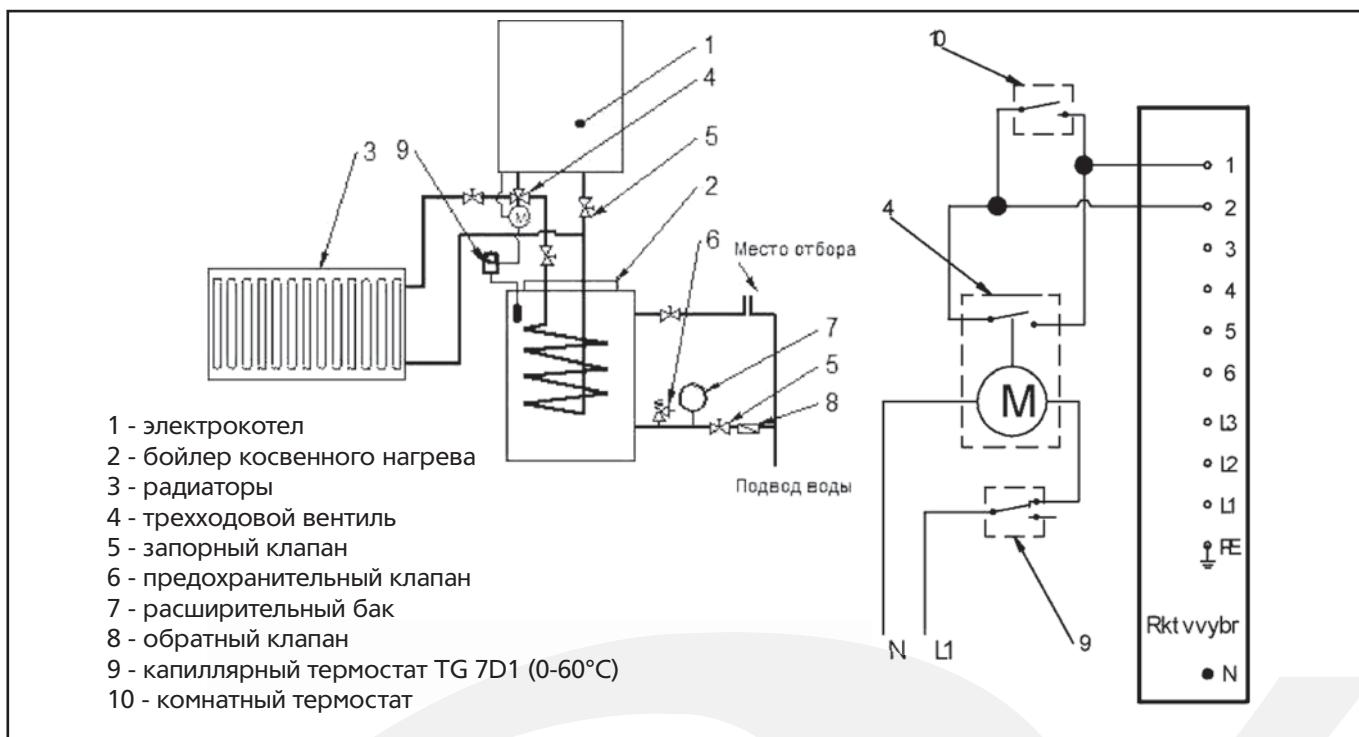
ника тепла, составной частью которого не является циркуляционный насос. Подключение должно быть произведено посредством терmostата минимума второго источника тепла (который надо подключить на клеммы 5, 6 котла ZETA), с помощью которого потом управляет насос котла. Это подключение можно выгодно применить при совместной работе с другим источником тепла, например с тепловым насосом, или камином с металлической топкой и т.п., когда уже не надо подключать в систему ни дальний насос, ни управление.
