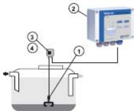
Рисунок 1: Система аварийной сигнализации сборника (уловителя) песка
