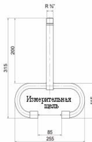
Рисунок 6: Габаритный чертеж для зонда WGA-SN
