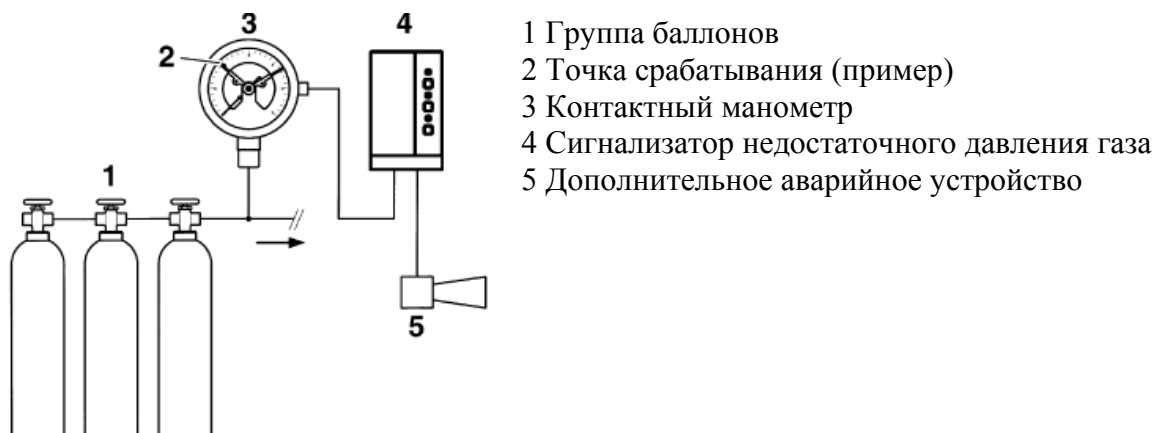
Рис. 3: Контроль над состоянием давления в группе баллонов
