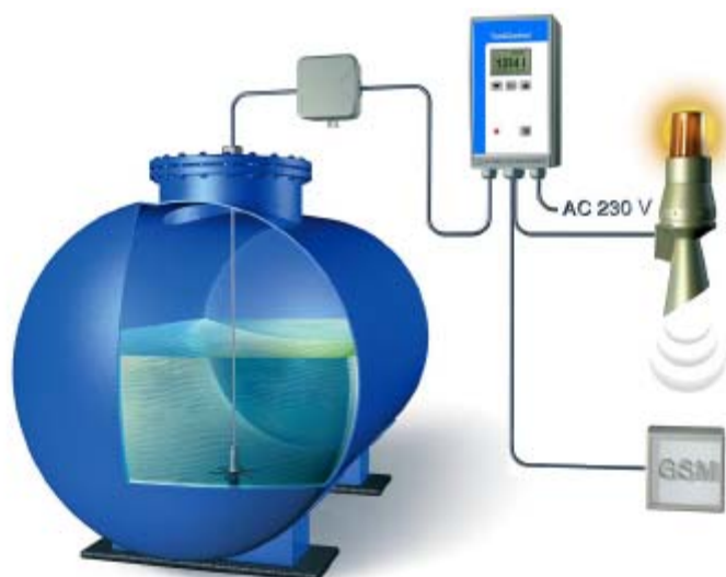
Рисунок 2: Пример применения прибора TankControl
