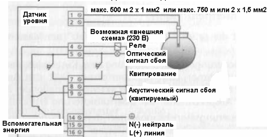
Рисунок 4а Схема подключения для NB 220 H
