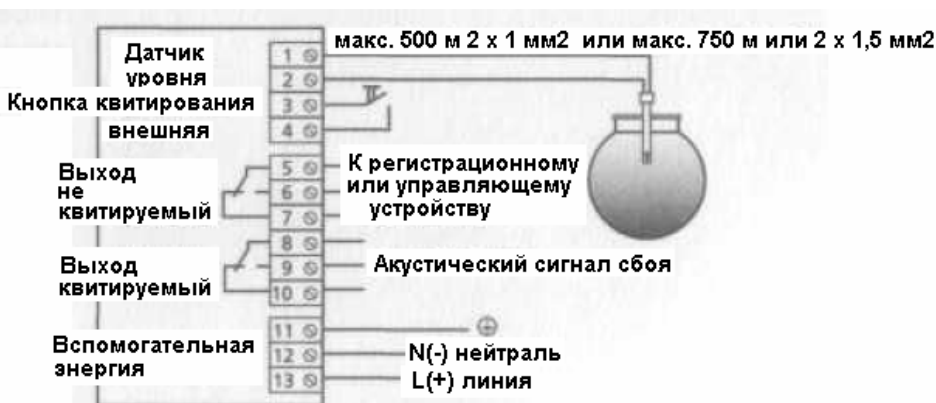
Рисунок 4а Схема подключения для NB 220 QSF
