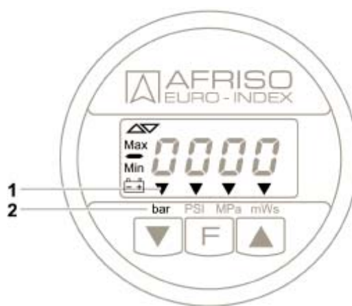
Рисунок 6-2: Индикация единицы измерения давления
