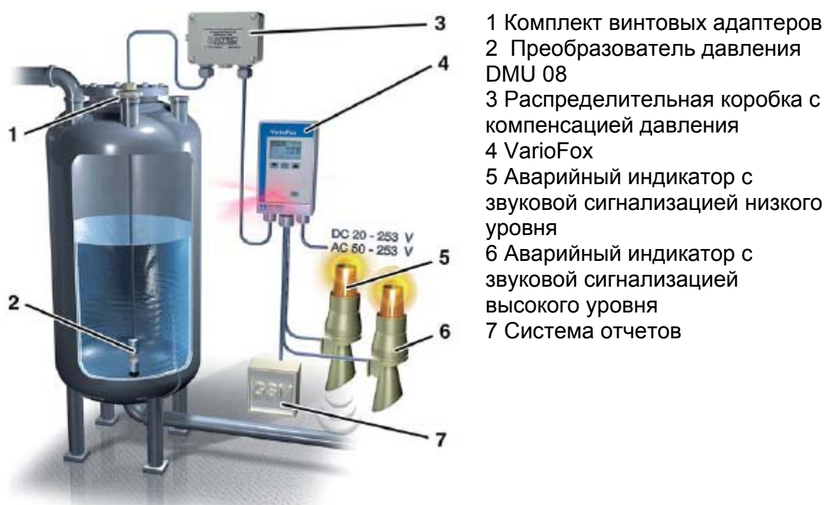
Рис. 27: Пример применения с преобразователем давления DMU 08
