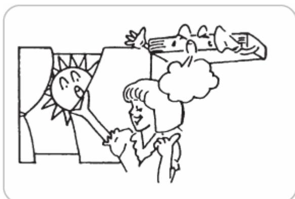
Чтобы воздух равномерно распределялся по комнате, в режиме охлаждения рекомендуется направить жалюзи как показано на рисунке, и включить покачивание жалюзи (SWING).
