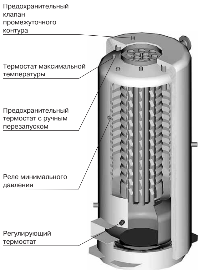
Предохранительные устройства котла Heat Master 150 Jumbo
